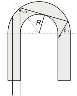
Der an dem Innenschenkel entlanglaufende einfallende Strahl hat von allen möglichen den kleinsten Einfallswinkel  $\alpha$ . Damit er totalreflektiert wird, muss gelten:
