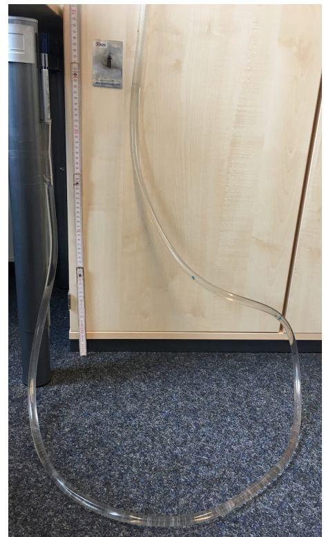
Abbildung 9: Versuchsaufbau zur Messung der Luftvolumenänderung als Funktion der Druckänderung.
