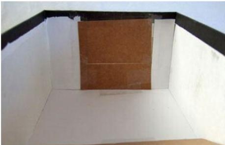
Die rechteckige Öffnung wird nun mit zwei dünnen Stücken Pappe verschlossen. Dabei soll zwischen den beiden Streifen ein möglichst schmaler Spalt gelassen werden.
