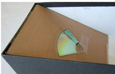
Fixiere die Rampe mit Klebeband im Schuhkarton. Klebe die CD auf die Rampe. Achte dabei darauf, dass die CD wie im Bild ausgerichtet ist. **Achtung:** Die CD soll in Aufgabenteil 1e) später gegen die DVD ausgetauscht werden!
