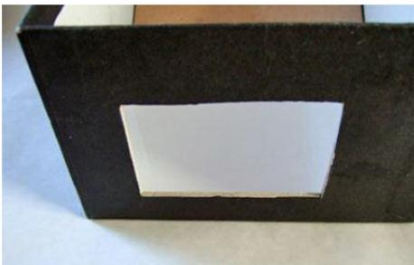
Schneide eine rechteckige Öffnung in die kurze Seite des Schuhkartons gegenüber der Rampe. Von hier scheint später das Licht in dein Spektroskop.
