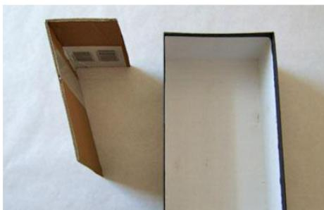
Schneide aus der Pappe eine Rampe. Die kurze Seite sollte dabei fast so hoch wie der Schuhkarton sein. Wähle die Länge der langen Seite so, dass sie mit dem Boden des Schuhkartons einen Winkel von ca.  $30^\circ$  bildet.
