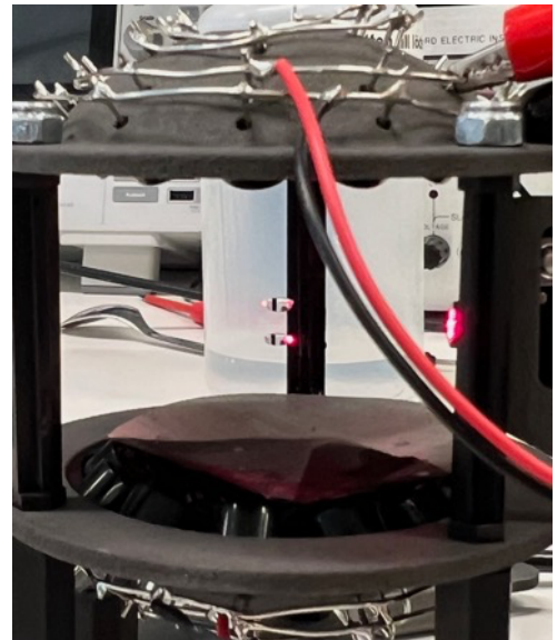
Schwebende Tropfen in einem Ultraschallfeld waren Bestandteil der experimentellen Klausur der EuPhO 2026.
