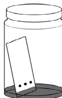
Abb. 1.2 DC-Platte in DC-Kammer
