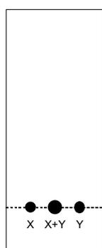
Abb. 1.1 Punkte auf der DC-Platte vor der Entwicklung;
