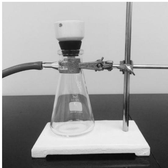
**Abb. 2:** Versuchsapparatur für die Vakuumfiltration
