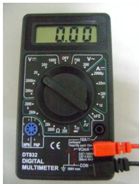
der Leitfähigkeitszelle anliegenden Spannung zur Verfügung. Schließt die Kabel an die Anschlüsse „COM“ und „VΩmA“ an und dreht den Drehregler auf 20V Gleichspannung (DC voltage).
