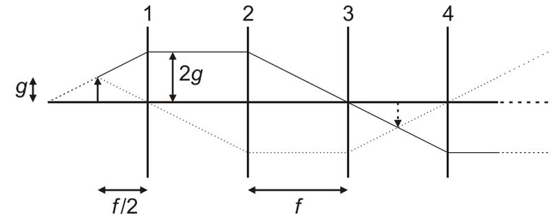
Direkt vor der vierten Linse verläuft der Strahlengang ähnlich wie vor der ersten Linse, nur dass der Strahlengang an der optischen Achse gespiegelt ist. Vor der siebten Linse ist der Strahlengang daher wieder der gleiche wie vor der ersten Linse.
