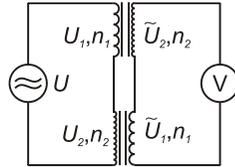
Durch die an die Spannungsquelle angeschlossenen Spulen muss nach der Knotenregel stets der gleiche Strom fließen. Nach dem Induktionsgesetz ist der Spannungsabfall über einer Spule proportional zur Induktivität  $L$  und der zeitlichen Änderung des Stromes. Die Induktivität wiederum ist proportional zum Quadrat der Windungszahl, so dass
