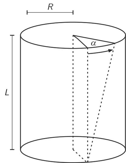
Abb. 4: Skizze zum verdrehten Zylinder.
