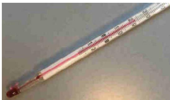
Abb. B4.1 | Thermometer mit roter Toluol-Füllung.
