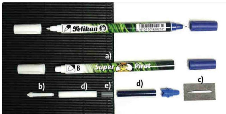
Faservlies mit Löschflüssigkeit und einem blauen Vlies mit Überschreib-tinte. Eine kleine Plastikabdeckung (e) in der Mitte verhindert das Mischen der beiden Flüssigkeiten innerhalb des Stiftes.
