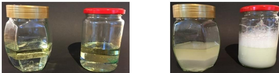
**Abb. C4.1:** In den beiden Fotos ist jeweils links ein Glas mit Öl und Wasser und rechts ein Glas mit Öl, Wasser und einem Tropfen Spülmittel zu sehen. Das linke Foto zeigt den Zustand vor dem Schütteln, das rechte kurz nach dem Schütteln. Mit Spülmittel sieht man deutlich eine Schaumbildung und kaum Entmischung, ohne Spülmittel ist die Entmischung von Öl und Wasser schon deutlich fortgeschritten.
