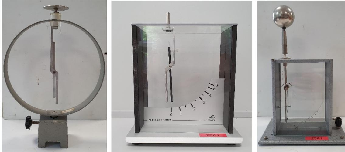
Abb. B3.3: Verschiedene Elektroskope
