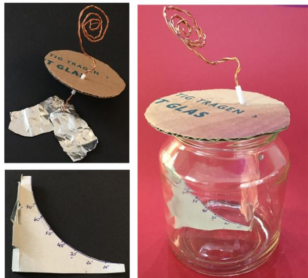
Abb. 3.1: Aufbau des Elektroskops
