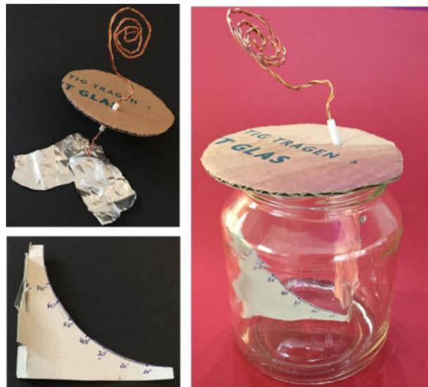
Abb. 3.1: Aufbau des Elektroskops
