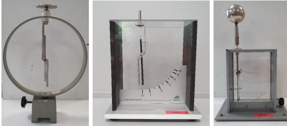
Abb. B3.3: Verschiedene Elektroskope
