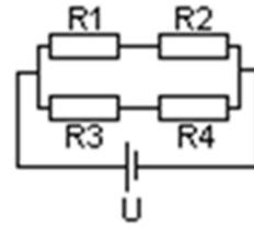
1a | Nun Begründe, warum die Gesamtspannung und die Gesamtstromstärke im oberen und unteren Zweig der Parallelschaltung gleich sind.
