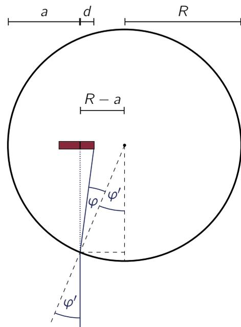
Da das Glas aus einer größeren Entfernung beobachtet wird, müssen die zum Beobachter laufenden Lichtstrahlen das Glas in dieser Aufsicht senkrecht nach unten verlassen. Mit den Bezeichnungen in der Abbildung ist
