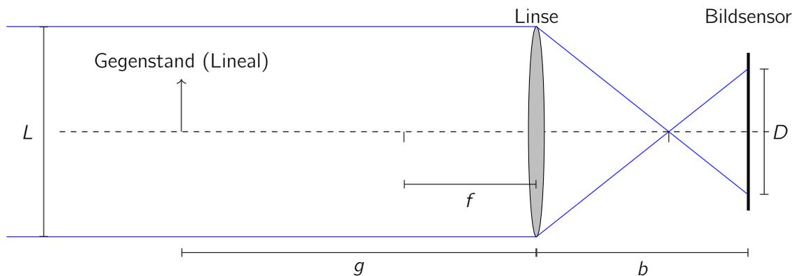
Abb. 2. Strahlenverlauf bei der Abbildung einer Lampe der Lichterkette.
