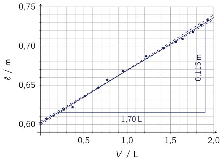
Abb. 5. Graph des vom Laserentfernungsmesser gemessenen Abstandes  $\ell$  in Abhängigkeit von dem Flüssigkeitsvolumen  $V$  im Zylinder mit Ausgleichsgerade.
