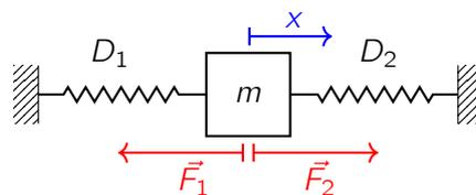
Im Gleichgewicht zieht jede Feder mit der Kraft  $F_0$ . Bei einer Auslenkung um  $x$  aus der Gleichgewichtslage üben die linke Feder den Kraftbetrag  $F_1 = F_0 + D_1x$  und die rechte Feder den Kraftbetrag  $F_2 = F_0 - D_2x$  auf  $m$  aus. Wir erhalten für die insgesamt auf die schwingende Masse  $m$  wirkende Kraft.
