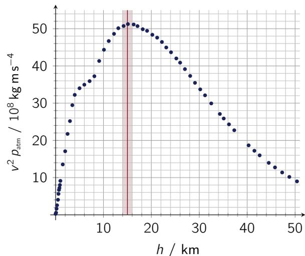
Abb. 7. Produkt  $v^2 \cdot p_{\text{atm}}$  beim Raketenstart in Abhängigkeit von der Höhe  $h$  über dem Erdboden.
