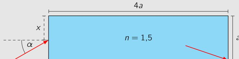
Abb. 11. Nicht maßstabsgetreue Skizze des Laserstrahls im Glasquader in der Seitenansicht.
