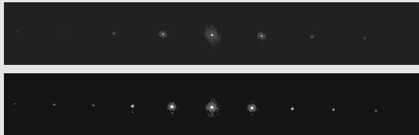
Abb. 14. Interferenzmuster auf dem Schirm für eine Wellenlänge von 650 nm (oben) und eine zweite unbekannte Wellenlänge (unten). Die Bilder zeigen den gleichen Ausschnitt des Schirms.
