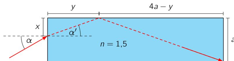
Abb. 12. Vollständige Skizze des Strahlenverlaufs im Glasquader in der Seitenansicht
