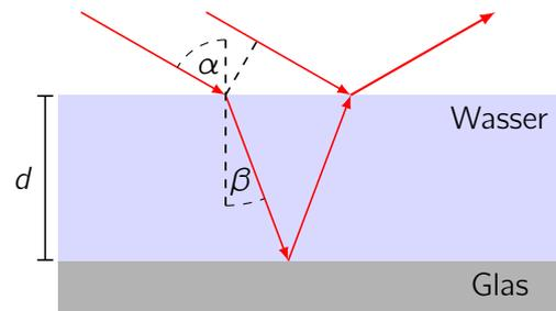
Abb. 16. Skizze zur Interferenzentstehung mit überhöhten Einfallswinkeln.
