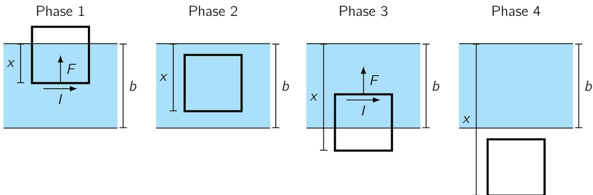
Abb. 6. Skizzen der vier Phasen des Falls der Leiterschleife.
