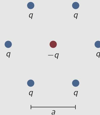
Abb. 5. Skizze der Anordnung. Die äußeren Teilchen besitzen jeweils eine Masse  $m$  und eine Ladung  $q$ , das zentrale Teilchen ebenfalls eine Masse  $m$  aber eine Ladung  $-q$ .
