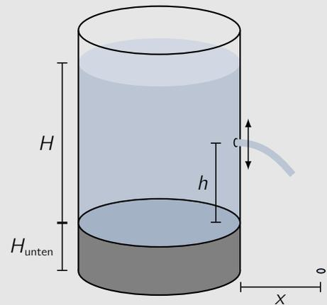
Abb. 2. Skizze zum Wasserstrahl.
