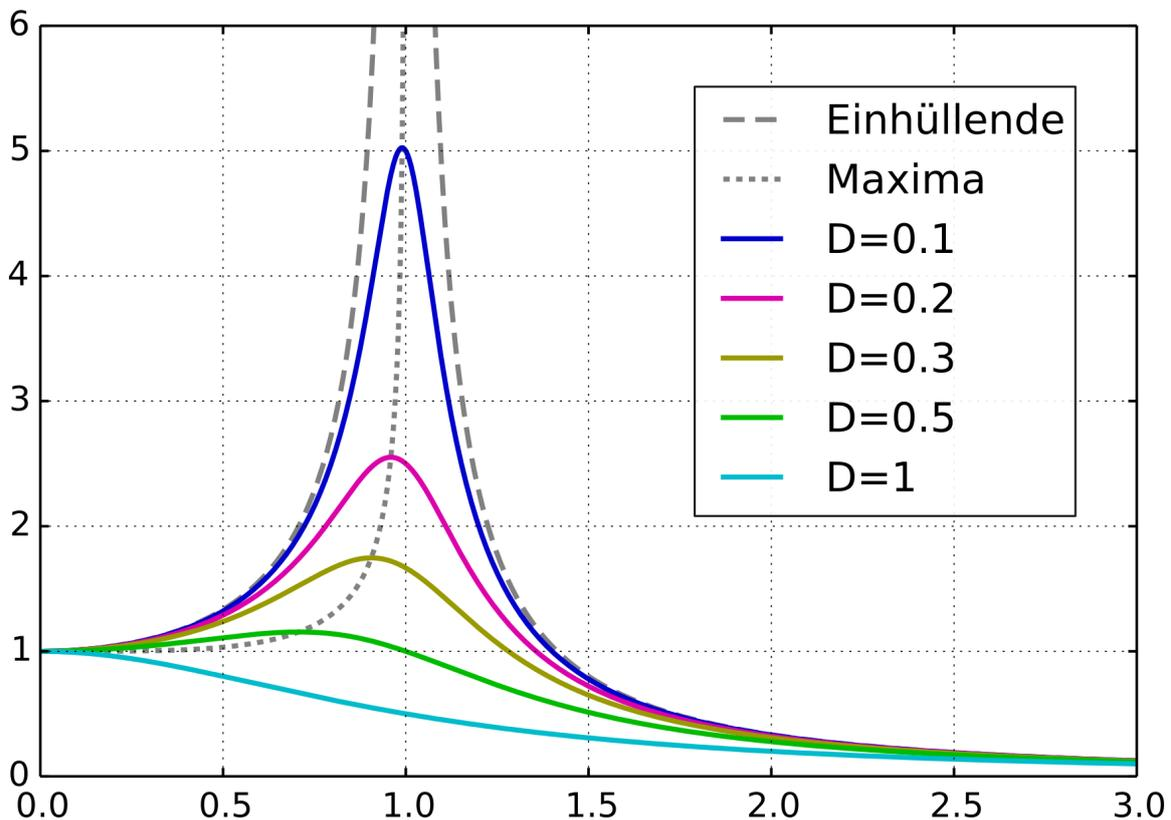
Abb. 2. Gezeigt ist die Amplitude  $\frac{A_2}{K}$  des angeregten Oszillators in Abhängigkeit des Frequenzverhältnis  $\frac{\omega}{\omega_0}$  für unterschiedliche Dämpfungskonstanten. Zu erkennen ist, dass mit sinkender Dämpfung das Maximum der Amplitude steigt. Bild von Geek3, CC BY 3.0
