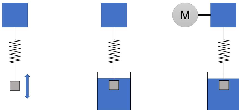
Abb. 1. Schematische Darstellung der drei verschiedenen Schwingungsmöglichkeiten. Links ist der ungedämpfte Fall gezeigt. In der Mitte und rechts, befindet sich die schwingende Masse in einer viskosen Flüssigkeit, die zu einer Dämpfung führt. Zusätzlich wird der Schwinger rechts von einem Motor ( $M$ ) angetrieben, was zu einer Anregung der Schwingung führt.
