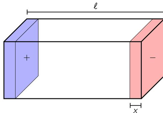
Abb. 1. Skizze zur Plasmaoszillation. An den Enden des Volumenelements befinden sich überschüssige Ladungsträger, links positiv geladene Ionen und rechts negativ geladene Elektronen.
