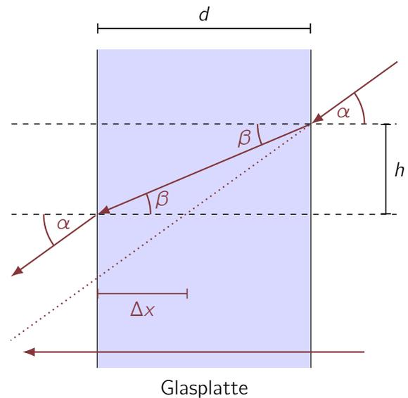
Abb. 3. Skizze zur Verschiebung eines Lichtstrahls durch Glasplatte. Der Einfallswinkel ist für eine bessere Darstellung größer gewählt als bei einem achsennahen Strahl.
