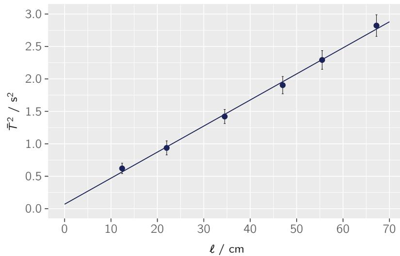
Abb. 4. Graph der quadrierten mittleren Schwingungsdauer  $\bar{T}^2$  des Fadenpendels als Funktion der Fadenlänge  $\ell$  mit Ausgleichsgerade. Die Unsicherheiten bei der Fadenlänge sind sehr gering und wurden nicht mit eingezeichnet.
