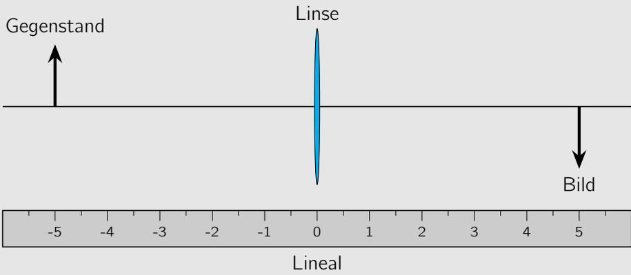
Bestimme die Brennweite der Linse. Verwende dazu das eingezeichnete Lineal als Maßstab. Zeichne außerdem das entstehende Bild ein, wenn eine zweite, identische Linse direkt hinter die erste gestellt wird.
