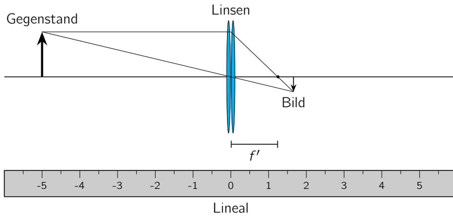
Abb. 1. Skizze zur Konstruktion des Bildes bei Abbildung durch beide Linsen.
