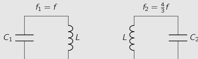
Wie groß ist die Schwingungsfrequenz  $f_{12}$  (Eigenfrequenz) des folgenden, gekoppelten Systems?
