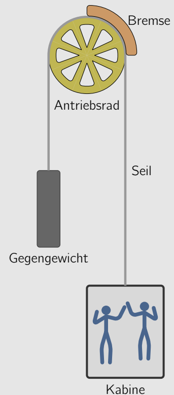
Abb. 2. Skizze des Fahrstuhls mit Aufhängung.
