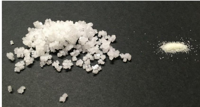
Abbildung 2: Die gebildeten Salzkristalle (links) im Vergleich zu den Salzkörnern, die ursprünglich gelöst wurden (rechts).
