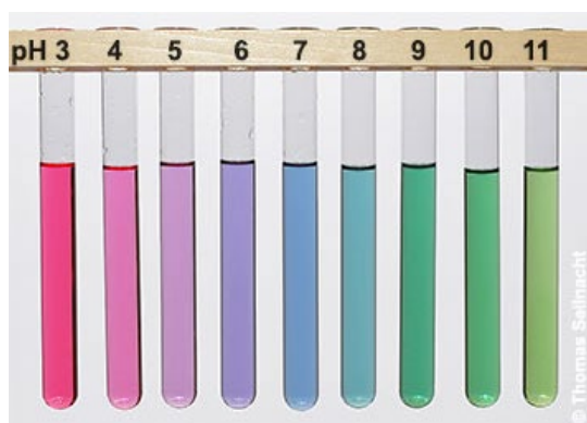
Abbildung B3.4: Farbspektrum von Rotkohlindikator
