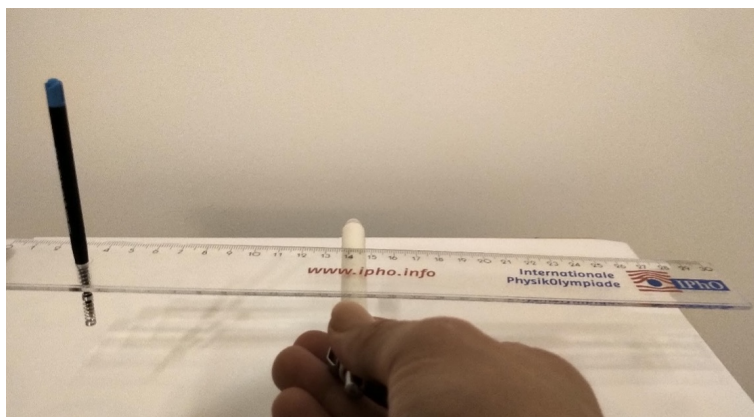
Abb. 8. Nutzung des auf der Kugelschreiberhülse balancierten Lineals als Balkenwaage.
