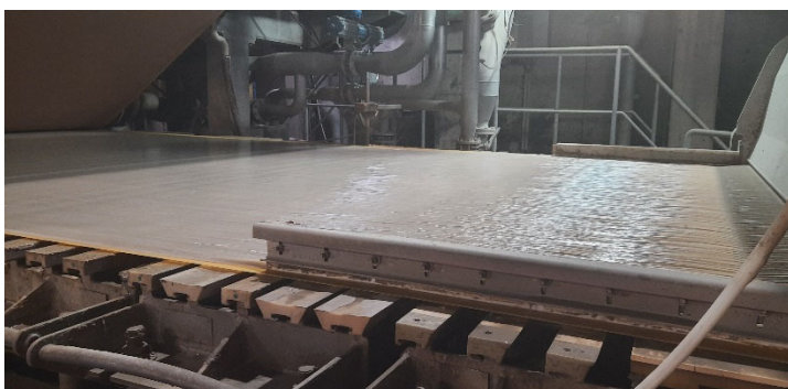
Abbildung B3.8: Papierbahn in einer Papiermaschine
