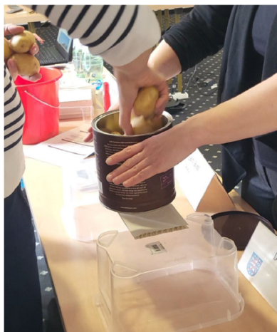
Abbildung B2.9: Belastung einer Papierbrücke mit Kartoffeln
