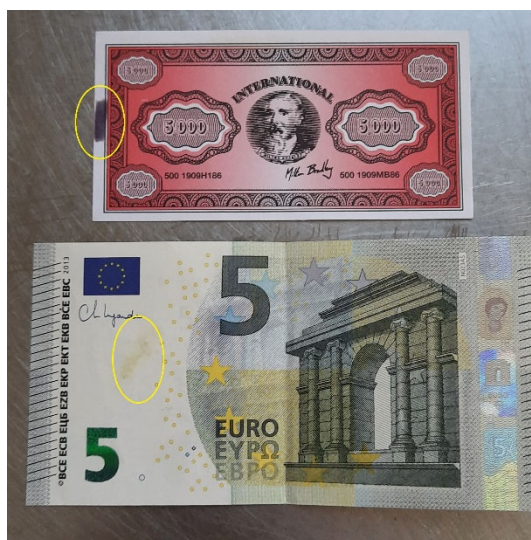
Abbildung B2.8: Teststriche eines Geldscheinprüfstiftes auf Echtgeld (unten) und Falschgeld (oben)
