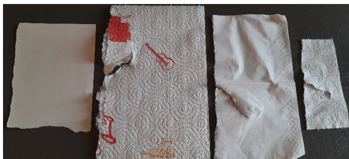
Abbildung B2.1: Zerreißprobe (von links nach rechts: 80 g-Papier, Küchenrolle, Papiertaschentuch, Toilettenpapier)
