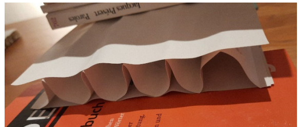
Abbildung B2.11: Zusammendrücken oder Ausbeulen der Zacken
