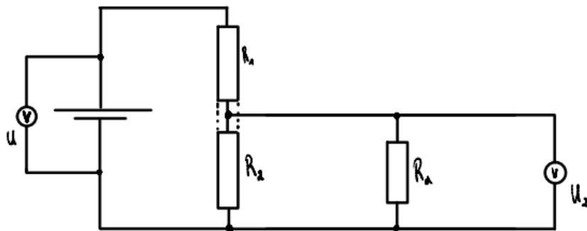
*R<sub>2</sub> & R<sub>a</sub> mit gleicher Spannung*
