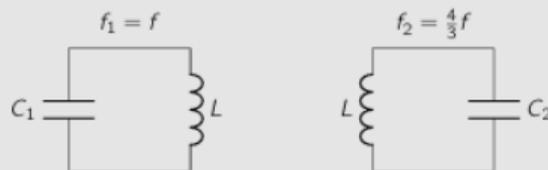
Wie groß ist die Schwingungsfrequenz  $f_{12}$  (Eigenfrequenz) des folgenden, gekoppelten Systems?
