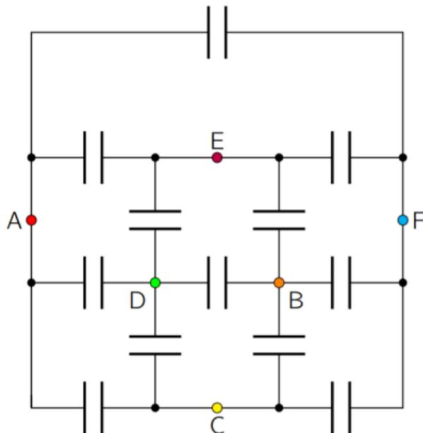
Abb. 9. Alternative Darstellung des ebenen Ersatzschaltbild des Kondensatornetzwerkes.
