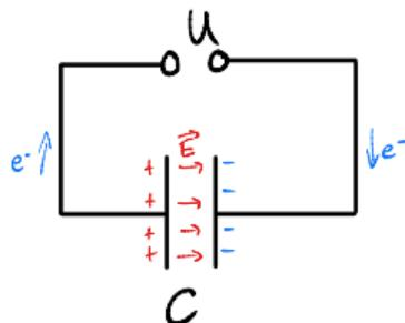
Am Kondensator maximale Ladung
