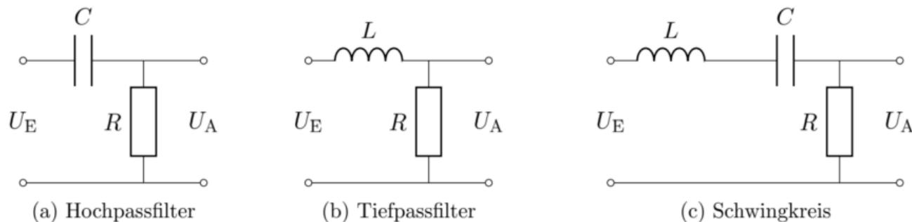
Abbildung 5: Verschiedene Wechselstromschaltung.
