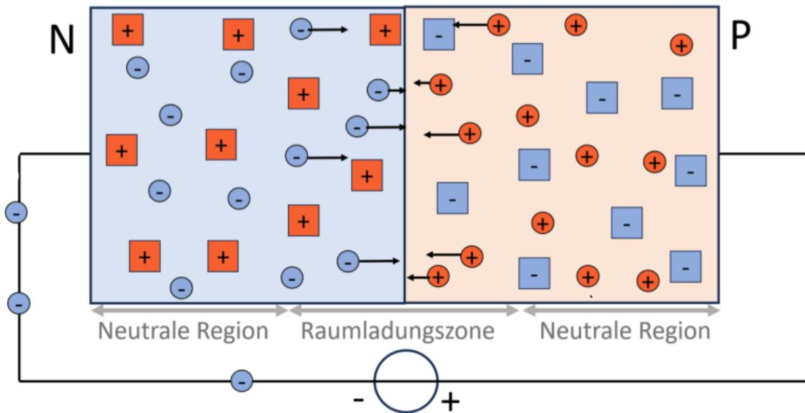
Durchlassrichtung: äußere Spannung als Gegenfeld zu innerer Spannung, kann  $U_G$  überwinden und Stromfluss ermöglichen
