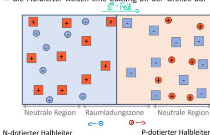
→ Diffusionsspannung  $U_G$  über gesamte Raumladung
